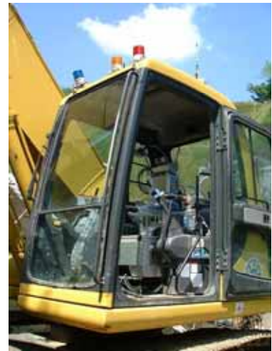
ロボQを搭載したバックホウ
